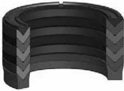
K04 Es un conjunto de estanqueidad de 7 piezas de simple efecto que consiste en un anillo de apoyo de caucho reforzado con tejido de algodón, un anillo de presión de termoplástico, tres anillos intermedios de caucho reforzado con tejido de algodón, y dos anillos intermedios de caucho NBR.
