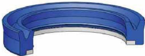
K32 es una junta de vástago de simple efecto de dos piezas que consiste en una junta de estanqueidad principal de elastómero diseñado especialmente con un labio adicional y un anillo antiextrusión de termoplástico.
