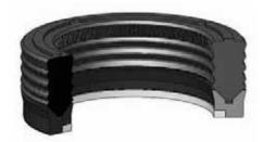
K34 Es una junta de simple efecto de tres piezas que consiste en un anillo de apoyo de caucho reforzado con tejido de algodón o un anillo de apoyo termoplástico, una junta de estanqueidad multi-labio de diseño especial en caucho NBR y un anillo antiextrusión.
