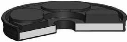
K55 es un pistón neumático de simple efecto con un núcleo metálico vulcanizado con caucho nitrilo mediante un método de fabricación especial.
