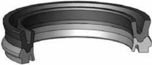
K56 es una junta de neumática de simple efecto de dos piezas formada por una junta de estanqueidad de nitrilo y un perfil rascador de poliéster.
