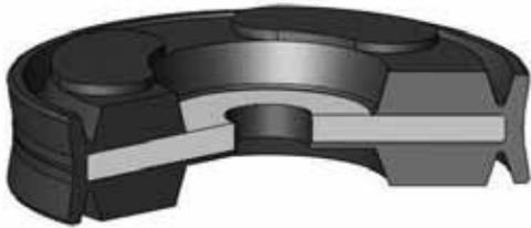
K57 es un pistón neumático de simple efecto con un núcleo metálico vulcanizado con caucho nitrilo mediante un método de fabricación especial.
